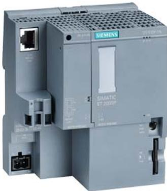
SIMATIC DP, CPU 1512SP-1 PN 针对 ET 200SP, 中央处理器, 带主存储器 200 KB 用于程序及 1MByte 用于数据, 第 1 个接口: PROFINET IRT 含 3 端口交换机, 48 ns 比特性能表现, 需要 SIMATIC 存储卡, 需要总线适配器用于端口 1 和 2
