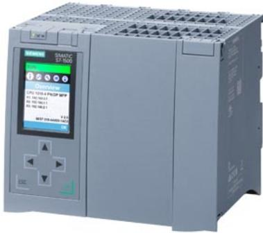
SIMATIC S7-1500, CPU Bundle 组成部分: CPU 1518-4 PN/DP MFP (6ES7518-4AX00-1AB0), 包括C/C++运行时间 OPC UA 运行系统许可证, 内存 6 MByte, 用于程序和 60MByte 用于数据, 第 1 个接口: PROFINET IRT 带双端口交换机, 第 2 接口: PROFINET RT, 第 3 接口: PROFINET 基础服务, 第 4 接口: PROFIBUS, 1 ns Bit-Performance, SIMATIC 存储卡(最小 2 GB) 必要
