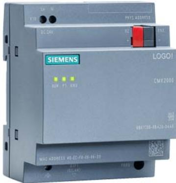
LOGO! CMK2000 通信模块，用于集成 LOGO! 8 "i"到楼宇系统总线 KNX 中；" 接头 24V DC 0.04A 1 RJ45 端口，用于以太网 50 个通信对象 时间同步 配置/诊断，通过 网络接口
