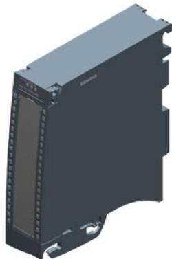
SIMATIC S7-1500, 模拟量输入模块, AI 8xU/I/R/RTD 标准型, 16 位分辨率, 精度 0.5%, 8 通道, 分成组, 每组 8, 共模电压 4 V DC, 诊断, 过程报警; 供货范围内包含 馈电元素, 屏蔽支架 和屏蔽端子: 前连接器 (螺钉型接线端子 或直插式) 单独订货
